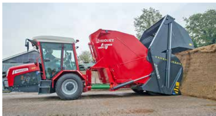
Die Futterentnahme erfolgt überwiegend mit Fräsen. Aber auch Strukturwalzen und Schneidschilder werden angeboten.
